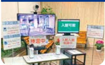
非接触型多人数サーモグラフィ式検温器と自動アルコール消毒液噴霧器及び人数カウントシステム
